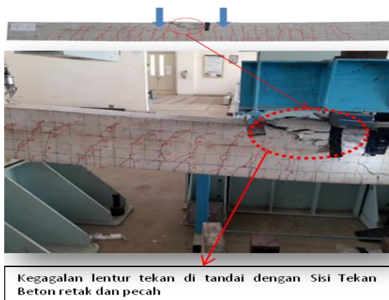
Gambar 12. Mode keruntuhan balok BFS
