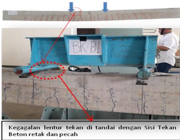
Gambar 11. Mode keruntuhan Balok Kontrol (BK)
